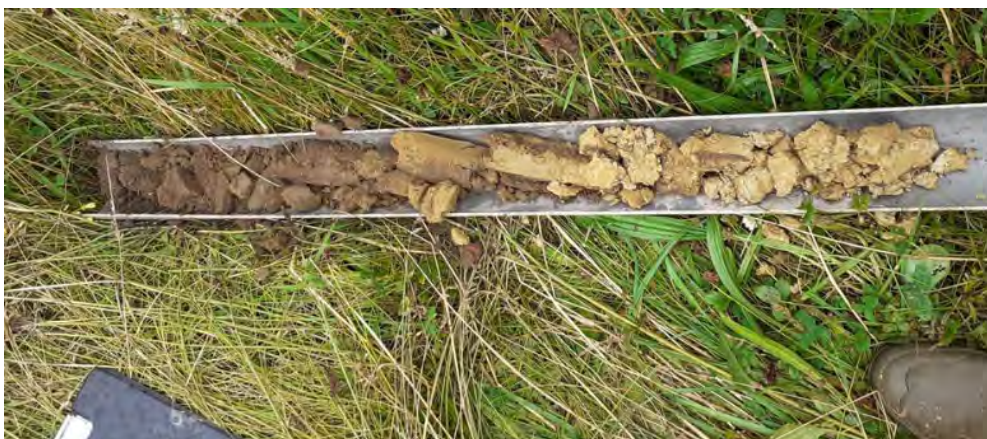
Sondage 26. Argile de décalcification jaune-olivâtre à gravillons calcaire résiduels passant graduellement en profondeur à des marnes calco-argileuse blanche crémeuse.
