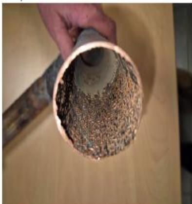
La corrosion des tuyauteries d'ECS est un phénomène courant, accéléré par la chaleur, la composition chimique de l'eau (pH, chlorures, dureté), et les matériaux utilisés (acier galvanisé, cuivre, etc.). Elle entraîne une dégradation progressive des conduites, pouvant affecter la qualité de l'eau, la performance du système et la sécurité des installations.
