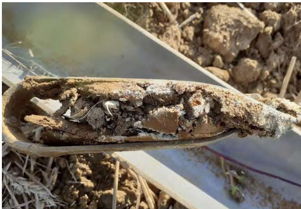
Argiles à silex ou argiles brunes à brunes-rougeâtres à silex résiduels sur craie sableuse indurée de faible profondeur.
