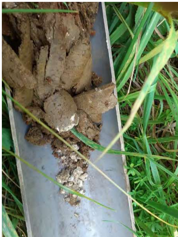
Argile lourde bariolée brune-verdâtre à larges tâches rouges-briques et concrétions ferro-manganiques noires au toit des calcaires gréseux. Transition et limite nette.
