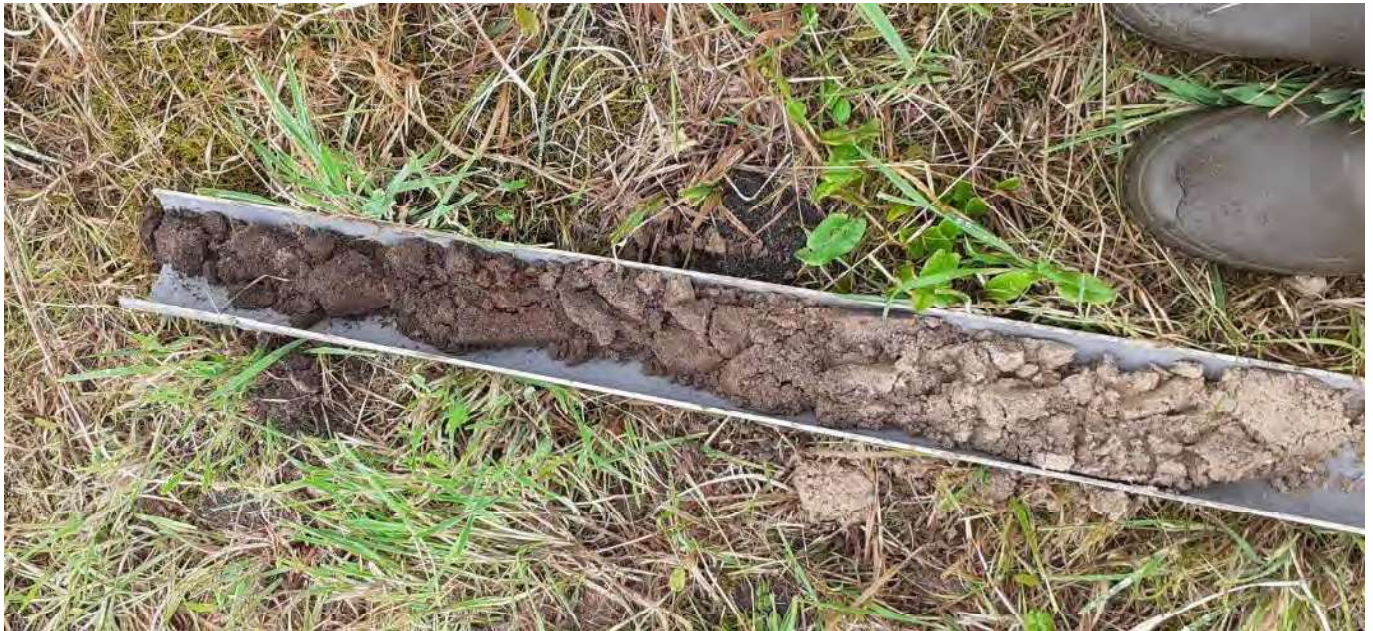
Sondage type – Arénosol sableux à caractère superficiel tourbeux s'atténuant progressivement avec la profondeur pour faire place à des sables alluviaux blonds propres.
