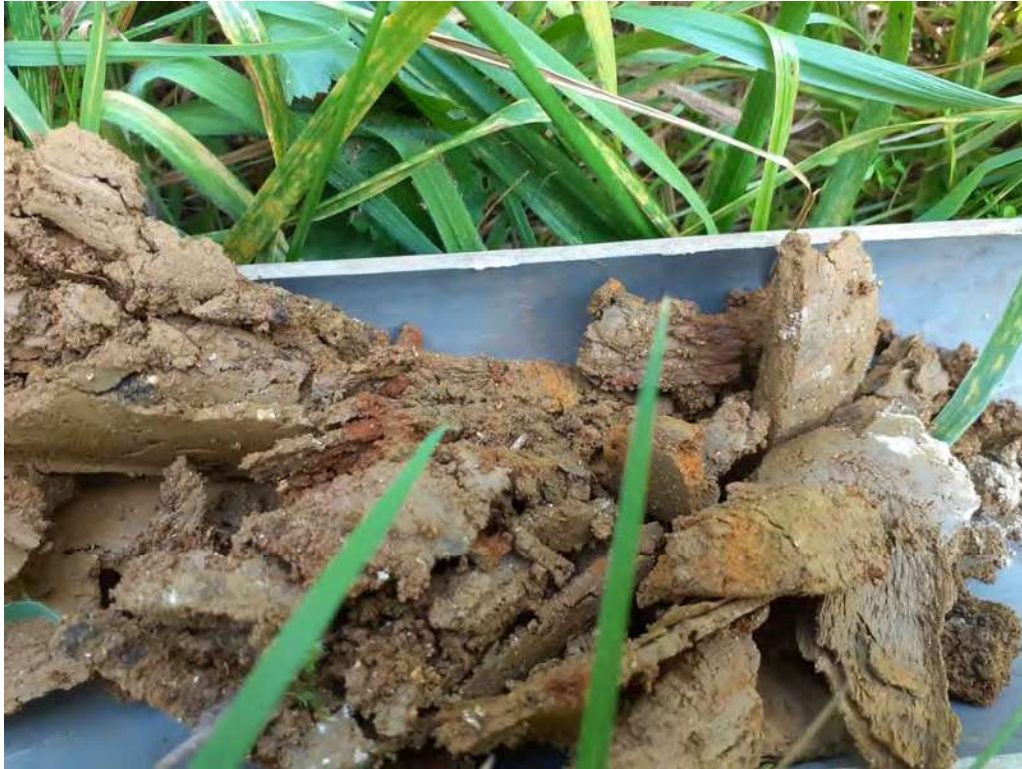
Argile lourde bariolée brune-verdâtre et ocre-orangée à larges tâches rouges-briques et concrétions ferro-manganiques noires au toit des calcaires gréseux
