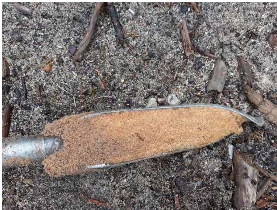
Sables blonds propres et bien calibrés caractéristiques des terrasses alluviales de « L'Huisne »
